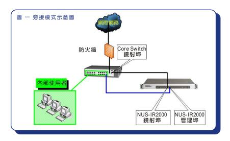
而限制鏡射埠回應封包的機制,可讓管理人員連線登入 NUS-IR2000 時,Core Switch 會將所有管理連線導向至管理埠,透過管理埠正常的封包收發機制,提供管理人員穩定的管理連線(如 圖二)。藉此改善因部分 Core Switch 設備只能單向傳送封包的功能缺陷,所導致管理人員無法正常登入 NUS-IR2000 之窒礙問題。
