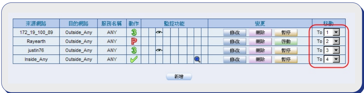
封包通过管制条例，由上而下逐条比对，所以需注意排列顺序
