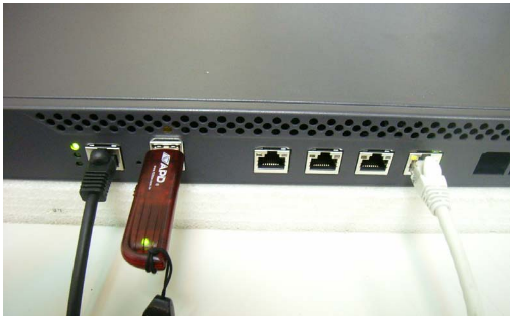
圖 1-12 將網路線連接至設備的網路埠
