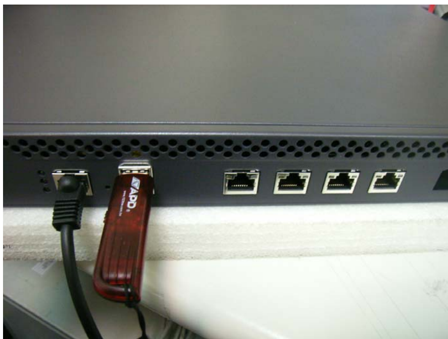
圖 1-9 插入 USB 隨身碟並連接 Console 線
